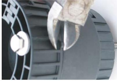
**2.** Dichtelement montieren wie vorher beschrieben. Für bündige Montage Anschlagnasen abzwicken.
