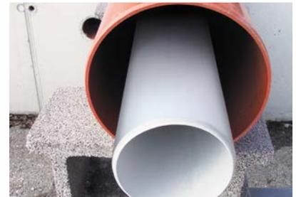
**6.** Für Kanalrohr DN 160 bzw. 200 verwenden Sie ein Setzungsschutzrohr  $\geq$  DN 250, für Mediumleitung 250 mm verwenden Sie ein Setzungsschutzrohr  $\geq$  DN 315 vorsehen; Auflager im Bereich der Kelleraußenwand herstellen.
