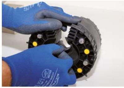
**2.** Dichtelement aufklappen. Zwiebelringe nach Erfordernis herausziehen, anschneiden und abreißen.
