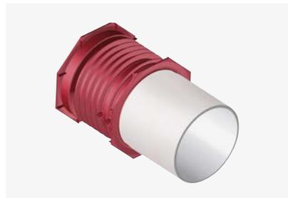
**8.** Bei Wandstärken 30–60 cm Einsatz des Lamellenrohres mit Baulänge 600 mm (A.-Nr. 01070, 01073 oder 01076).
